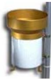
Figura 11. Pluviómetro. El pluviómetro de báscula es ampliamente utilizado en estaciones meteorológicas Fuente: RED, M E. (2017)
