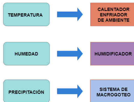
Figura 45. Dispositivos para controlar microambiente Fuente. Autor
