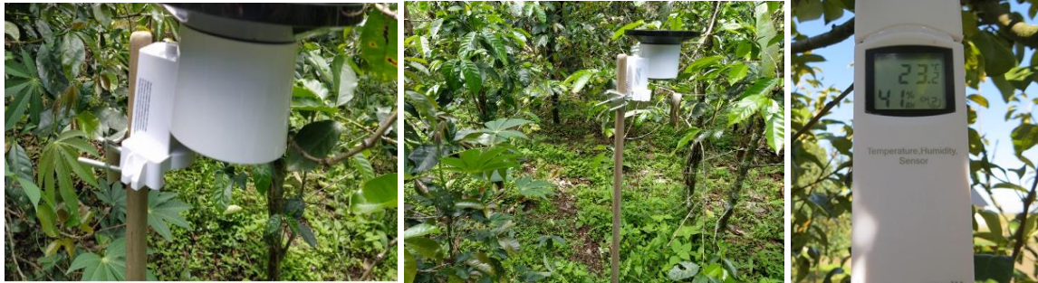
Figura 21. Nodo Sensor. Instalación de nodo sensor en el cultivo, utilizando un mástil para el sensor de pluviometría y fijando el sensor de humedad y temperatura a la mata de café. Fuente. Autor.
