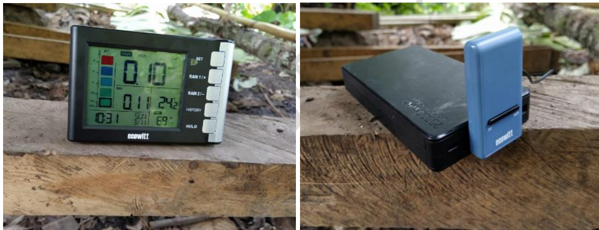
Figura 22. Gateway y terminal. Unidad receptora de información con información recibida para revisión de recepción de datos y Gateway con soporte de energía. Fuente. Autor.
