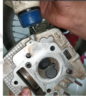
Figura 18 prueba de fuga
