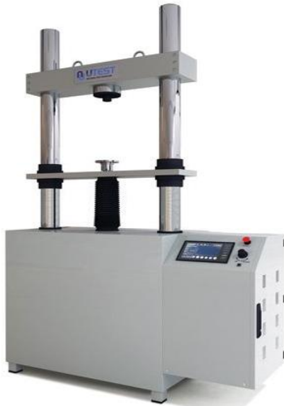
Figura 2 Máquina universal electromecánica (UTEST, 2016)
