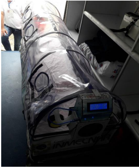
Figura 5 Sistema mecánico, sistema de ventilación y filtrado y sistema de automatización instalado en la unidad móvil. (investigación, 2020)
