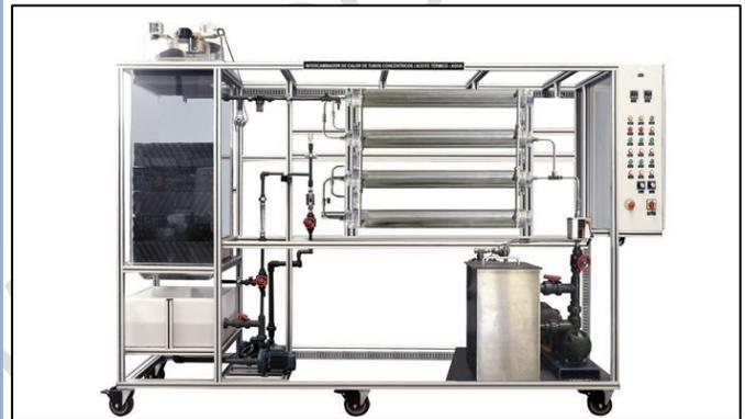
Imagen 1. Intercambiador de calor de tubos concéntricos (aceite térmico-agua ).
