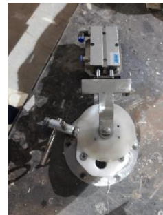
Ilustración 1. Ensamblaje del cilindro y cuchilla, para el corte de la masa en porciones iguales
