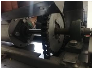
Ilustración 1. Piñón conducido ensamblado al eje del tornillo sin fin
