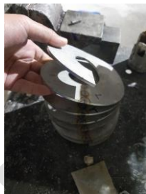
Ilustración 1. Unión de arandelas con soldadura
