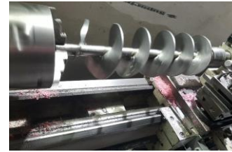
Ilustración 1. Rectificación de tornillo sin fin en torno
