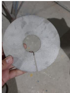
Ilustración 20. Arandela en lámina inoxidable cortada en laser para más precisión
