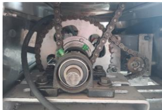
Ilustración 2. Piñones conductores, ensamblados al motor
