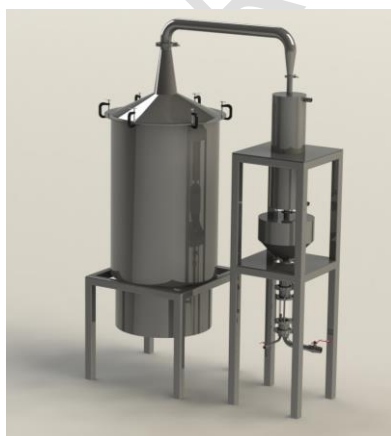
Fig. 9. Diseño 3D destilador de aceite esencial.
