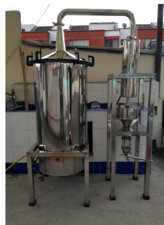
Fig. 10. Etapa final de construcción del destilador.
