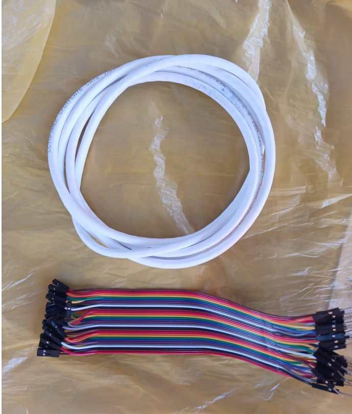
Ilustración 36: Cable UTP y Jumpers
