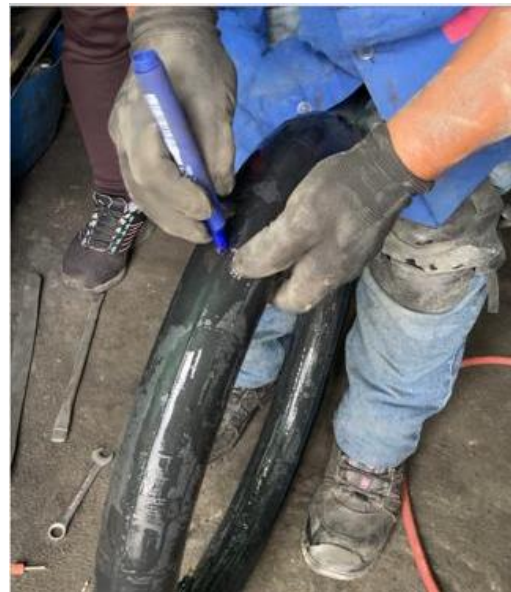
Fig. 4 Marcación del punto defectuoso
