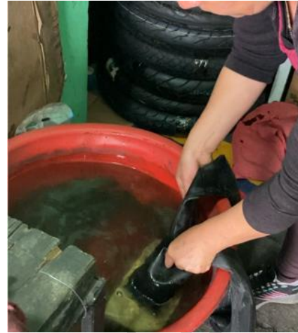
Fig. 8 Proceso de enfriamiento del neumático.
