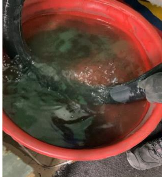
Fig. 3 Proceso de identificación de neumático roto.
