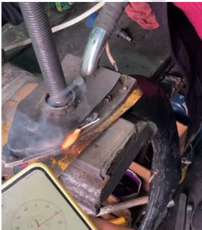
Fig. 7 Proceso de vulcanización artesanal.
