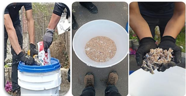
Fig. 2: Proceso de trituración envases Tetra Pak. Fuente: Esta investigación.
