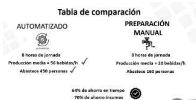
Gráfica 3. Comparativa final de un proceso manual y un automatizado bajo los mismos parámetros de trabajo
