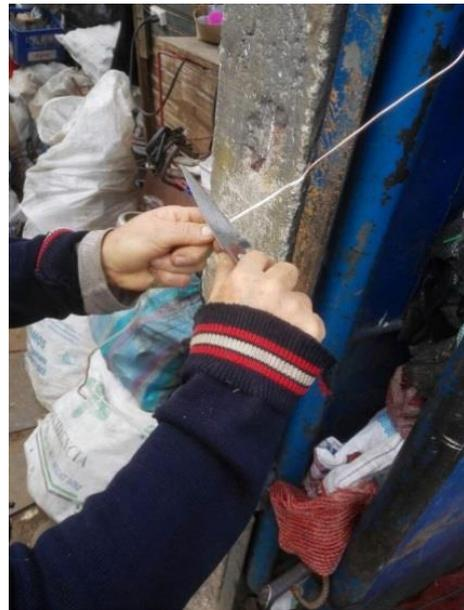
Fig. 2: Pelar alambres de forma manual
