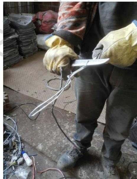
Fig. 3: Pelar alambres de forma manual
