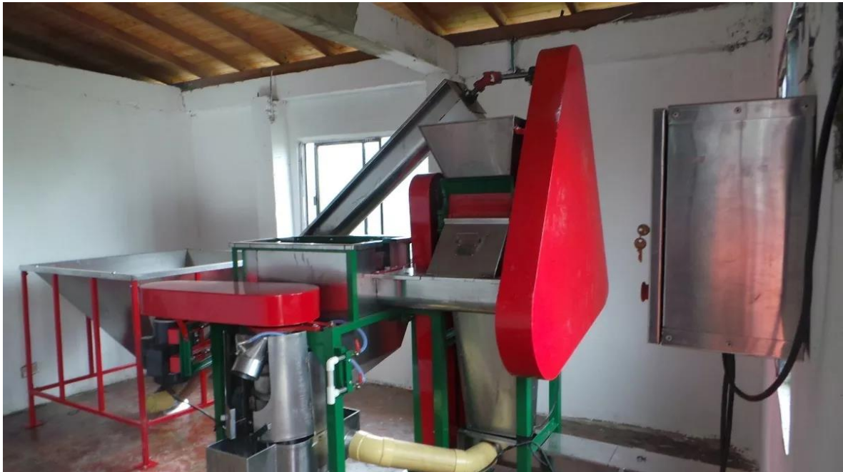
Grafico 20. Maquina secadora a Gas JM 200 Kilos capacidad
