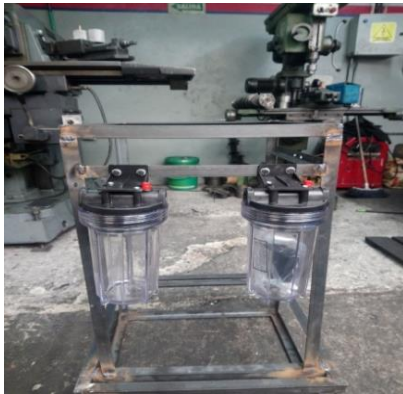
Figura 2. Estructura visible del prototipo de máquina para el lavado interno de motores y posterior filtrado de aceite.
