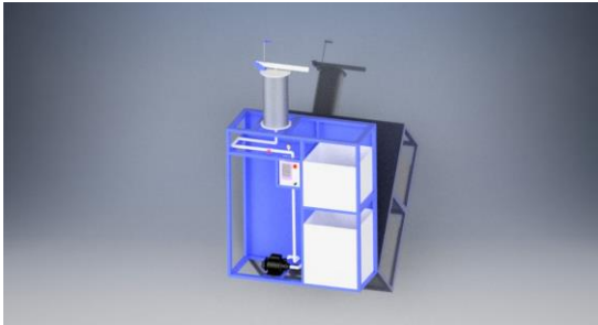
Fig5. Diseño computacional de banco de pruebas de chorro
