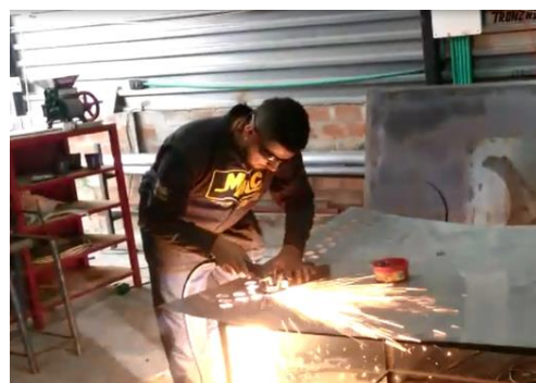
Fig. 2 Perforación a lámina:
