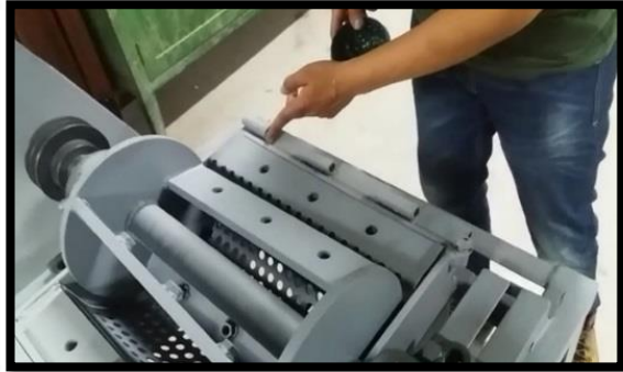
Fig. 8. Lubricación de bisagras que sujetan la tolva a la cámara de triturado
