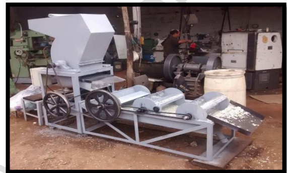
Fig. 11. Molino con separador de sólido ensamblado y primera prueba de funcionamiento.
