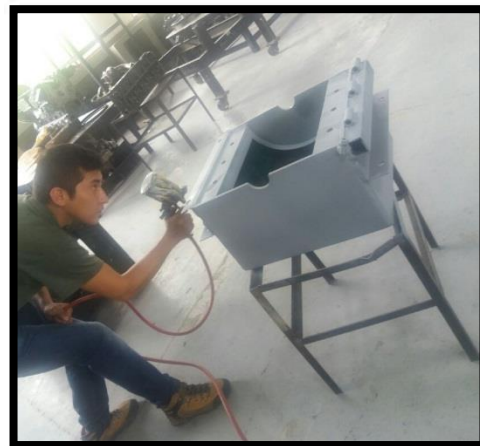
Fig. 7. Construcción de cámara de triturado
