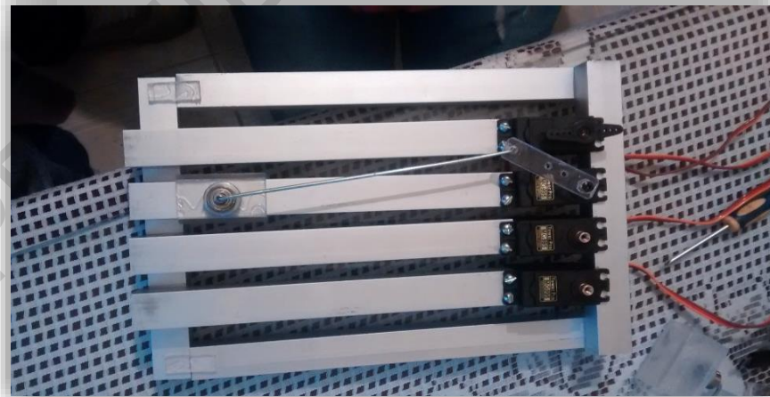
Figura 40. Ensamble de la estructura principal y servomotores
