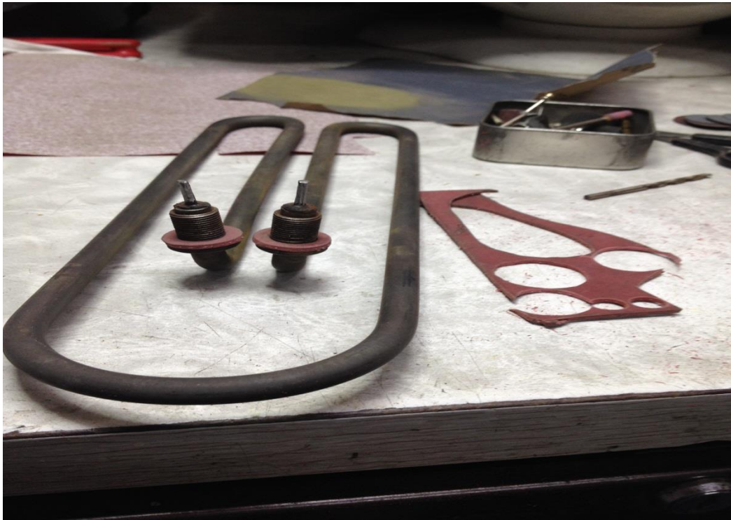
Figura 68 Adecuación de los empaques aislantes de siliconado
