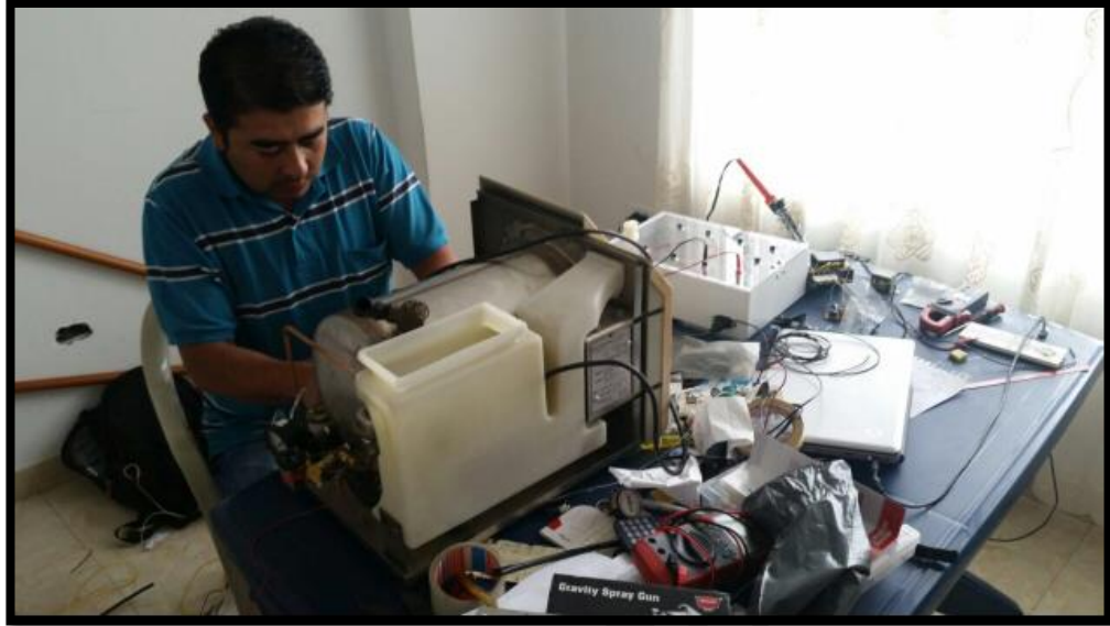
Figura 105 Conexión de cableado entre las tarjetas electrónicas y la planta
