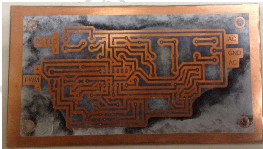
Figura 91 Tarjeta PWM después tratamiento con ácido
