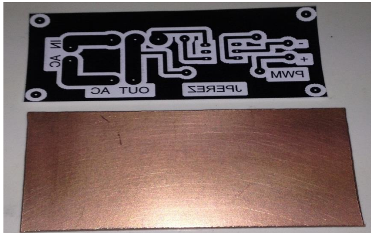
Figura 83 Impresión a laser circuito PWM
