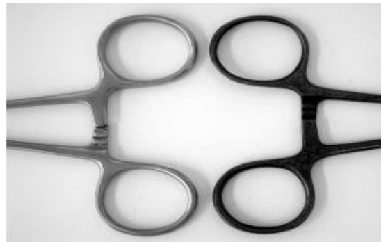
Figura 10 Pinzas Hemostáticas tras 20 ciclos de esterilización por vapor con agua de mala calidad
