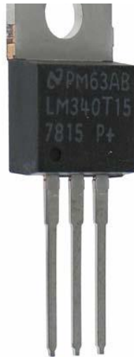
Figura 19 Regulador de voltaje 7815
