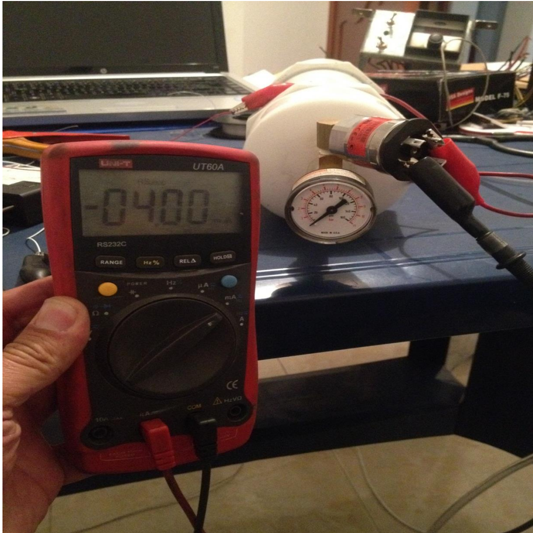
Figura 82 Verificación del sensor de Presión con respecto a la corriente
