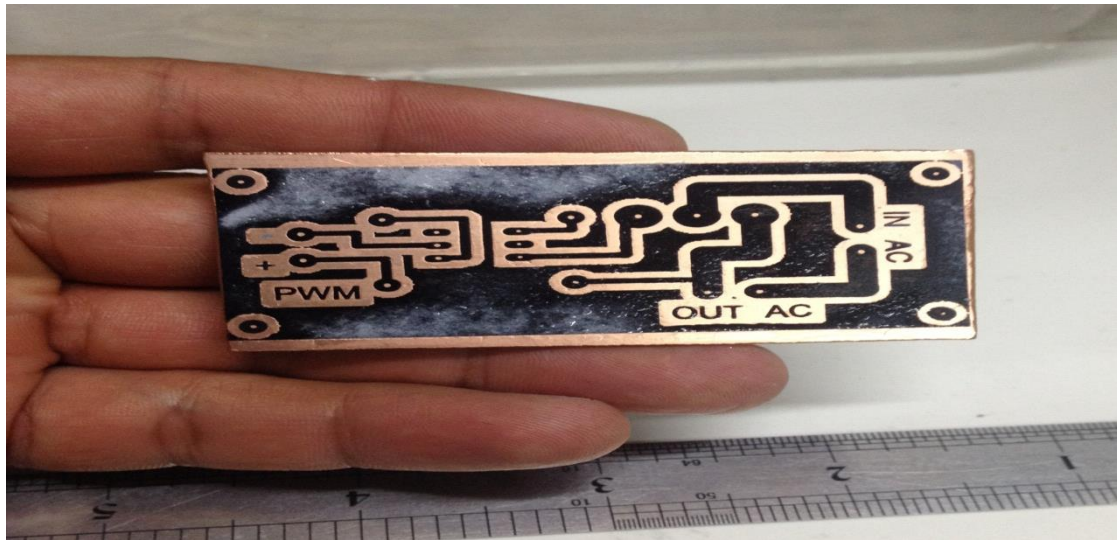
Figura 84 Proceso estampado térmico de impresión
