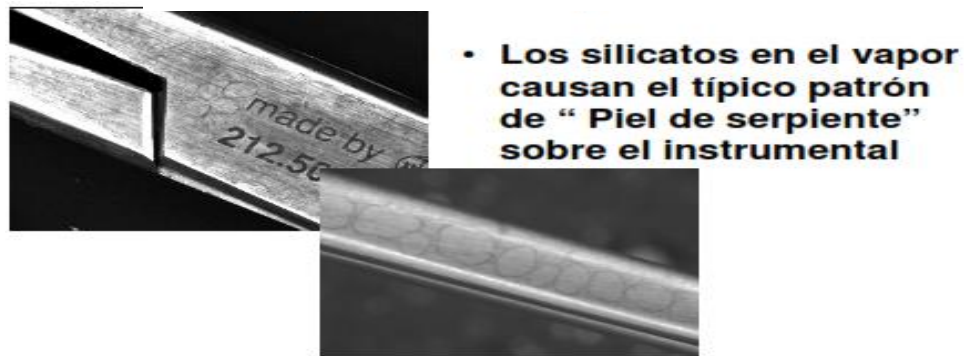
Figura 11 presencia de silicatos en el vapor
