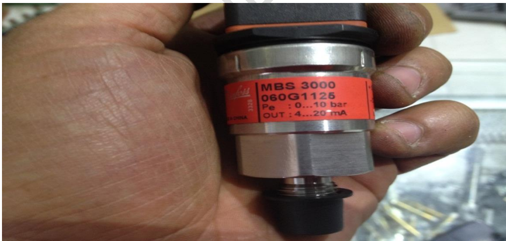
Figura 72 Datos impresos en el sensor Danfoss
