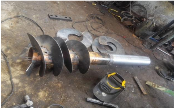
Figura 9, acople y soldadura
