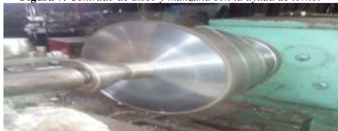
Figura 7. Centrado de disco y manzana con la ayuda de torno.
