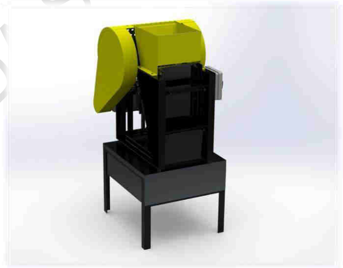
Fig. 3. Diseño del prototipo de máquina trituradora.
