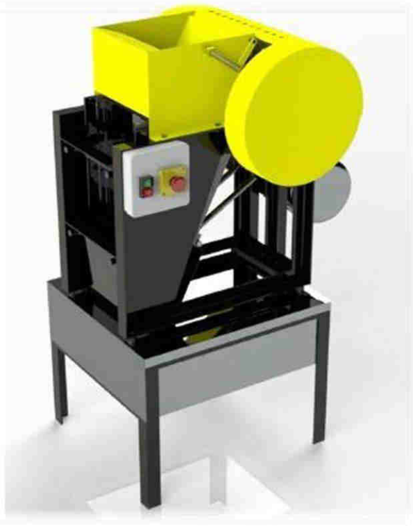
Fig. 4. Diseño final del prototipo de máquina trituradora.
