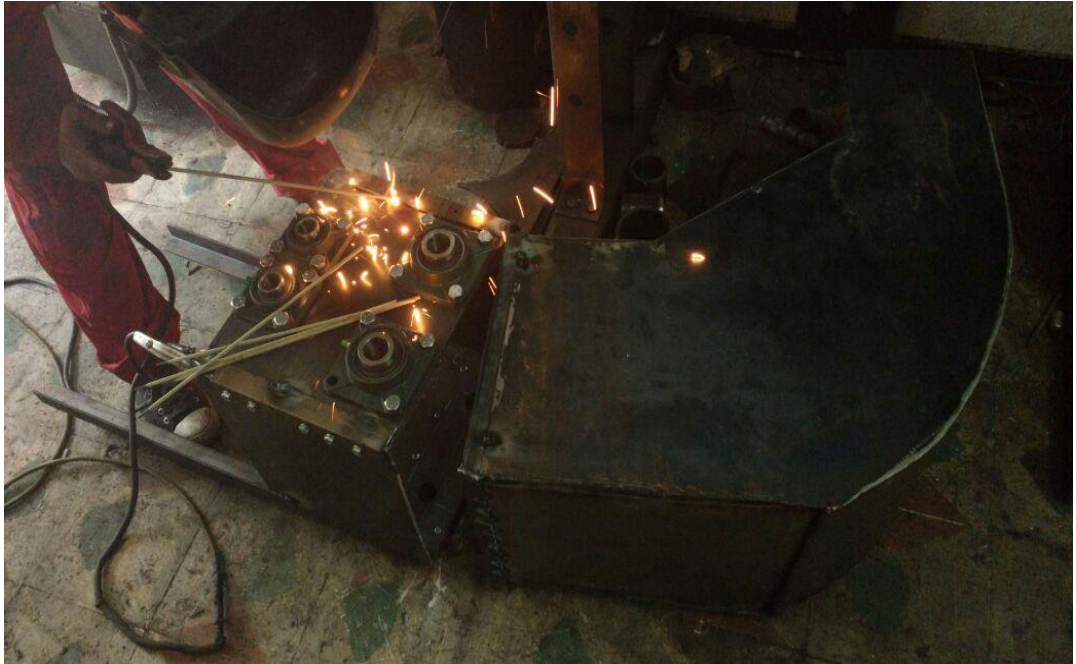
Figura 28. Imagen de construcción de la cámara para ubicar los rodillos
