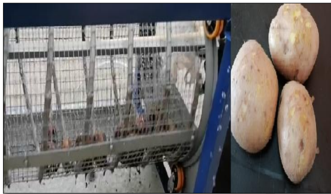
Figura 8. Experimentación lavada con cepillo de goma
