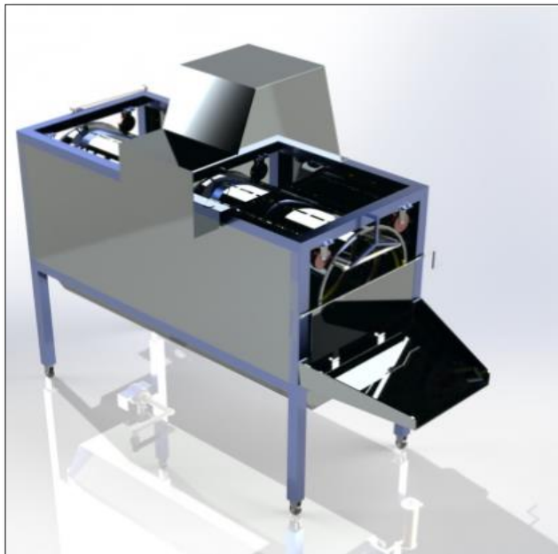
Figura 5. Diseño, prototipo de máquina lavadora.
