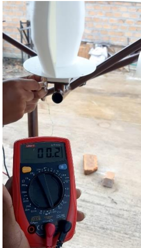
Figura 5. Pruebas de voltios con multímetro
