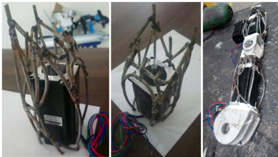
Figura 12. Ensamble estructura robot manipulador
