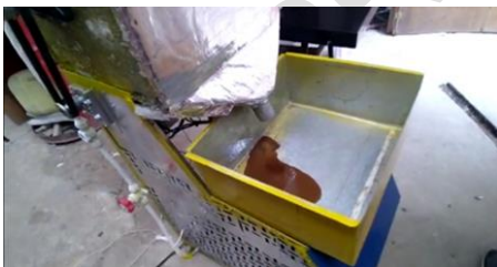
Figura 7. a) Ingreso de Café con Mucilago. b) Retiro del Mucilago del Café (Investigación, 2019).
