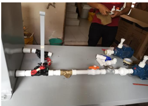
Figura 8. Implementación electroválvula de 1pulg. Fuente: La presente investigación.
