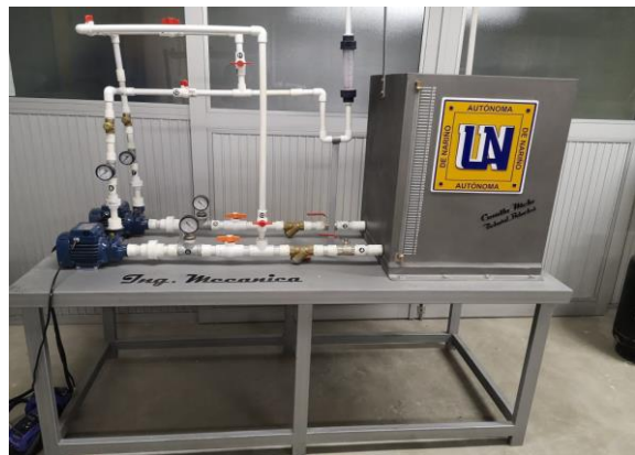
Figura 1. Banco de pruebas hidráulico para generar experimentalmente curvas características.
