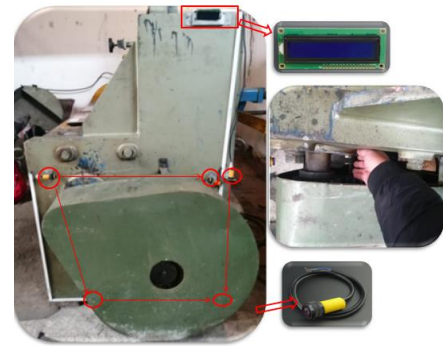
Figura 5. Montaje de sensores de proximidad infrarrojos (Martinez, 2020)
